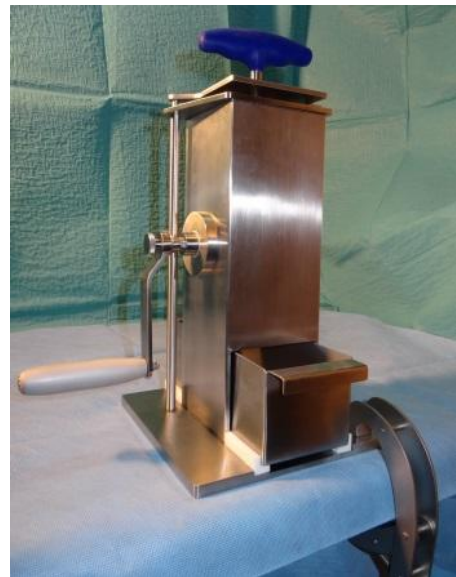
Abbildung 3: stabile Fixierung mittels Spannhand
